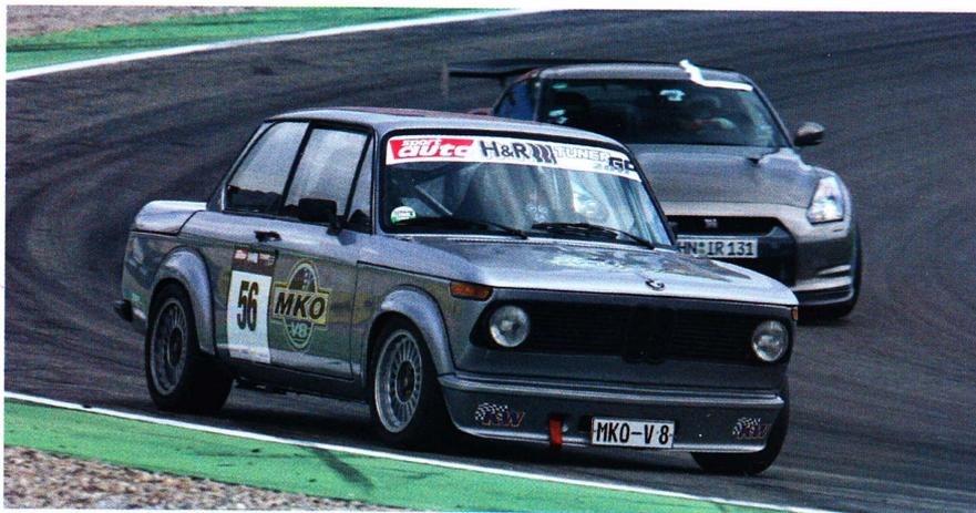
Un différentiel à glissement limité a été monté pour permettre aux 286 chevaux et 400 Nm de couple de passer au sol.
