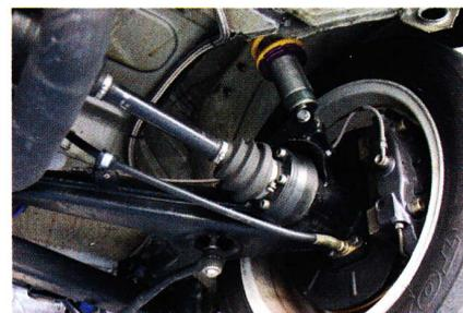
Les amortisseurs sont des KW phase 3 à ressorts hélicoïdaux.
