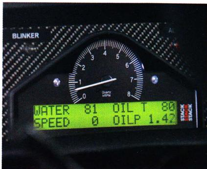
La gestion électronique est couplée à un ordinateur de bord Stack pour s'assurer du bon fonctionnement du moteur.
