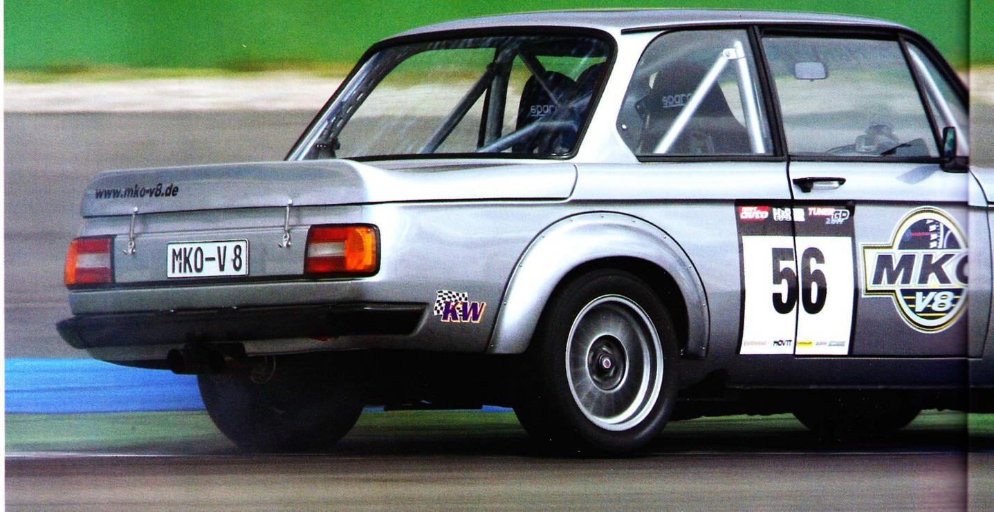
C'est une carrosserie de 3.0 Cs montée sur un châssis de M5 (E39) raccourci ! La base vient d'une 1502 vert pomme.
