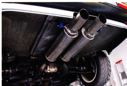
La ligne d'échappement est en inox et les catalyseurs sport permettent de gagner un peu de puissance.
