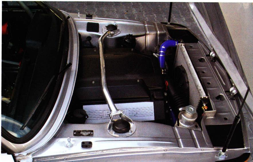
Le V8 est rentré dans le compartiment moteur, mais le plus reculé possible contre la cloison du cockpit pour un meilleur équilibre des masses ! Une barre anti-rapprochement d'ailes avant en alu a même été montée.
