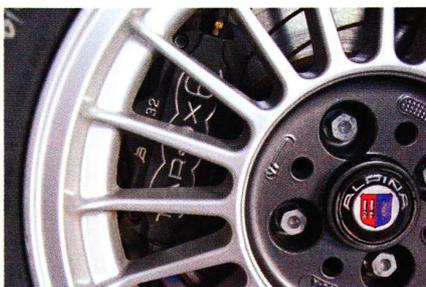
Des disques de 300 mm stoppent l'auto qui est très légère (1150 Kg). Les pinces sont des étriers Tarox 6 pistons à l'avant et Brembo 4 pistons à l'arrière.
