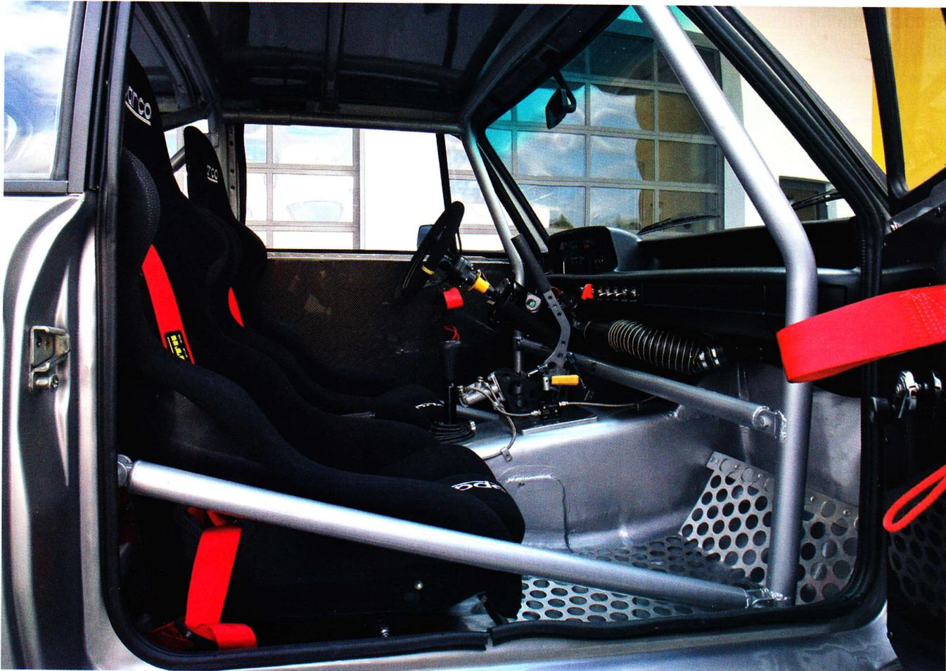
Tout l'intérieur est dépouillé. Exit les sièges arrière. Ne reste que l'arceau et barres de renfort, un volant Racing OMP, des panneaux de porte allégés en carbone, des baquets Racing Sparco et des harnais Schroth 5 points.
