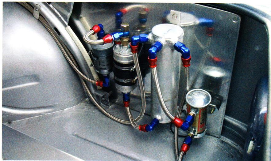
Les pompes de débit carburant ont été placées contre la face intérieure de l'aile arrière droite, dans le coffre, pour une meilleure répartition des poids. Elles alimentent le moteur via toute la longueur de la caisse. Le boîtier électronique et la batterie ont trouvé refuge dans le coffre aussi.
