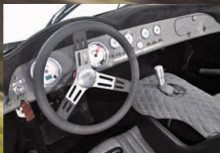
**Retro-Look:** Analoge Rundinstrumente, Kipphelbel und Airbag-freies Dreispeichen-Lenkrad, unter der Karosserie sitzt eine Stahlrohrrahmen-Konstruktion. Walter Scherrer (li.) holte den ersten LC470 auf den europäischen Kontinent
